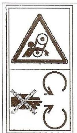
При работающем двигателе не открывайте и не снимайте предохранительную крышку!
